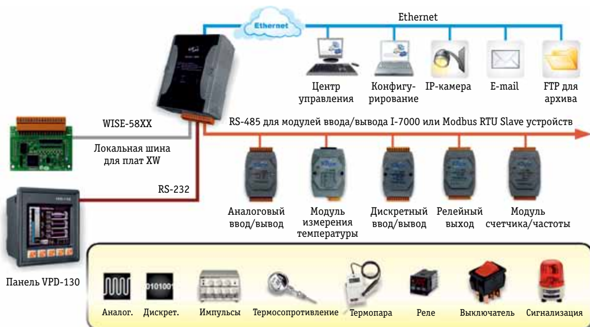
Рис. 1. Основные компоненты системы на базе WISE-580x
