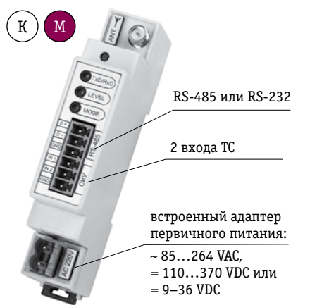
Рис. 2. ZigBee Pro-модем AnCom RZ/B. Крепление на DIN-рейку. Диапазон температур: -40...+70°C
