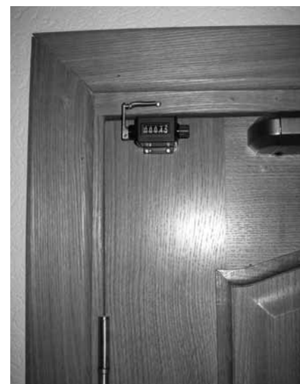
Рис. 1. Пример установки механического счетчика ходов (дверь) производства компании Lineseiki
