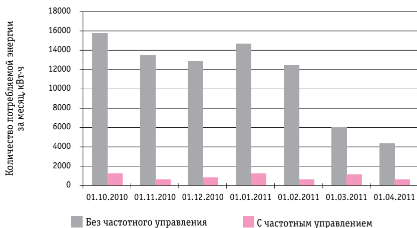
Рис. 3. Сравнительные результаты замеров расхода электроэнергии насосных агрегатов без частотного управления и с частотным управлением
