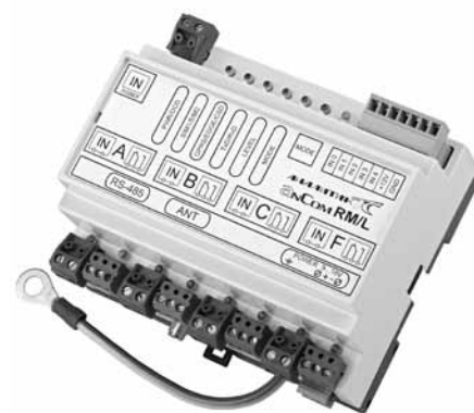
Рис. 1. Контроллер АСУНО AnCom RM/L: RS-485, реле управления электромагнитными пускателями, входы контроля фазных напряжений и охранно-пожарной сигнализации, встроенный GPRS/EDGE модем
