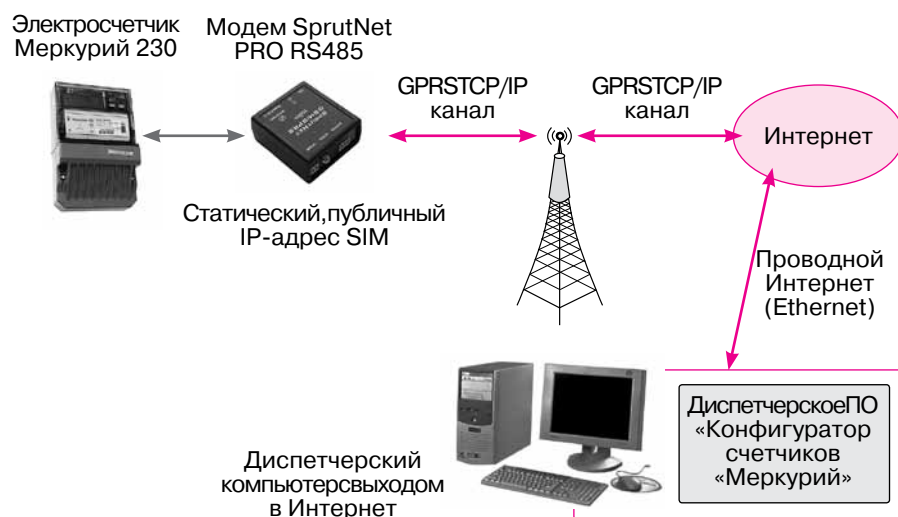
Рис. 1. Структурная схема стенда для демонстрации опроса счетчиков
