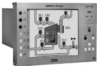
▲ Универсальный промышленный контроллер БАЗИС-21.2ЦУ
