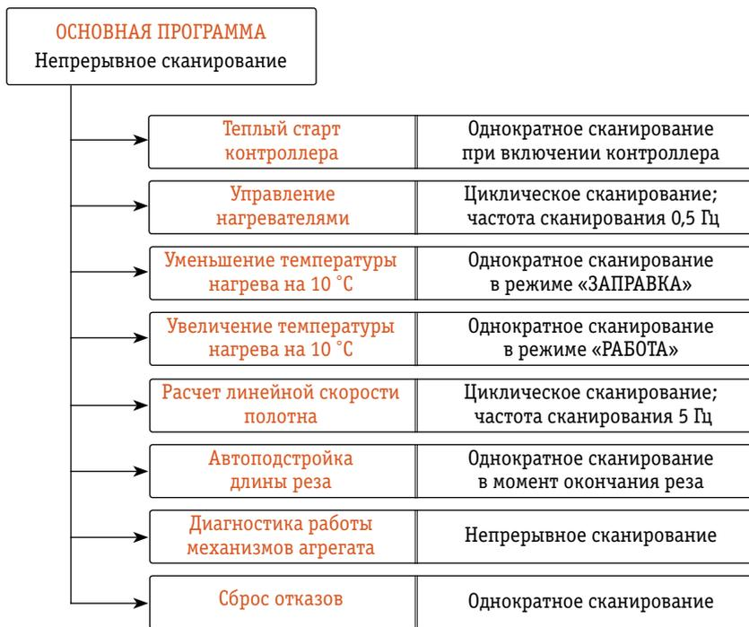
Рис. 3. Блок-схема управляющей программы контроллера TWIDO
