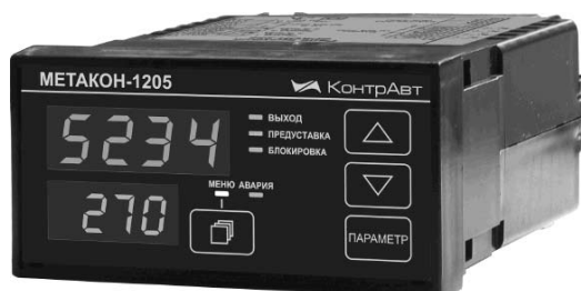
Рис. 1. Внешний вид контроллера «Метакон-1205», расположение органов индикации и управления на передней панели
