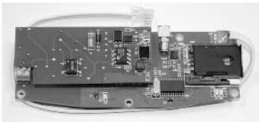
Рис. 2. Встраиваемый GSM-модем TELEOFIS для подключения к счетчикам «Альфа» производства компании Elster Metronica
