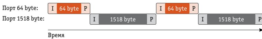
Рис. 2. Конфигурация нагрузки при скорости передачи данных 100%
