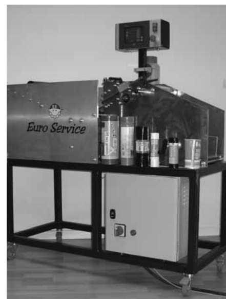
▲ Машина для нанесения разметки на пластиковые пакеты. В качестве устройства управления используется графический контроллер LT3201A
