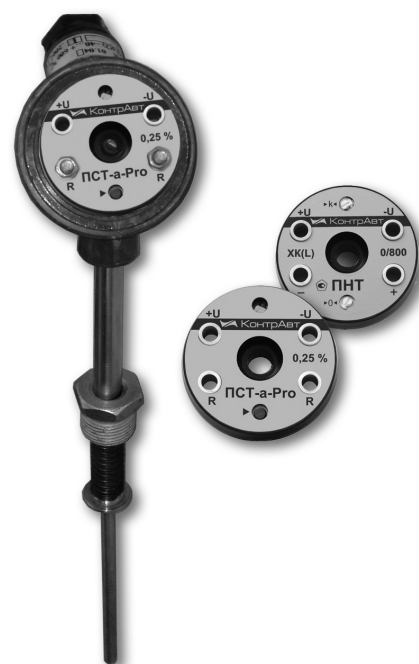
Рис. 1. Стандартная 4-клеммная карболитовая головка
