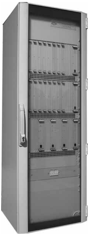
▲ Шкаф из состава системы автоматизации регуляторов питания парогенераторов Белоярской АЭС
