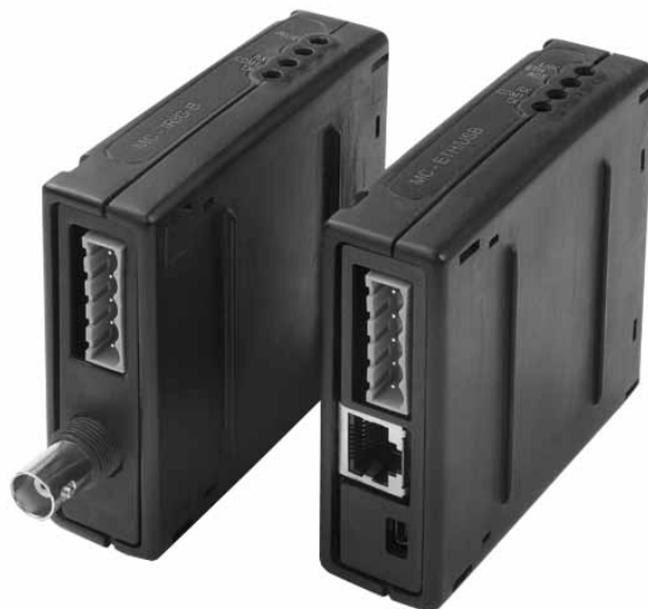
▲ Сменные модули для включения счетчика в АСКУЭ: порт Ethernet (протоколы Modbus/TCP и DNP3/TCP, в будущем – IEC 61850), обеспечивающий до 5 одновременных соединений; беспроводной GSM/GPRS-модем (протоколы Modbus/TCP и DNP3/TCP)
