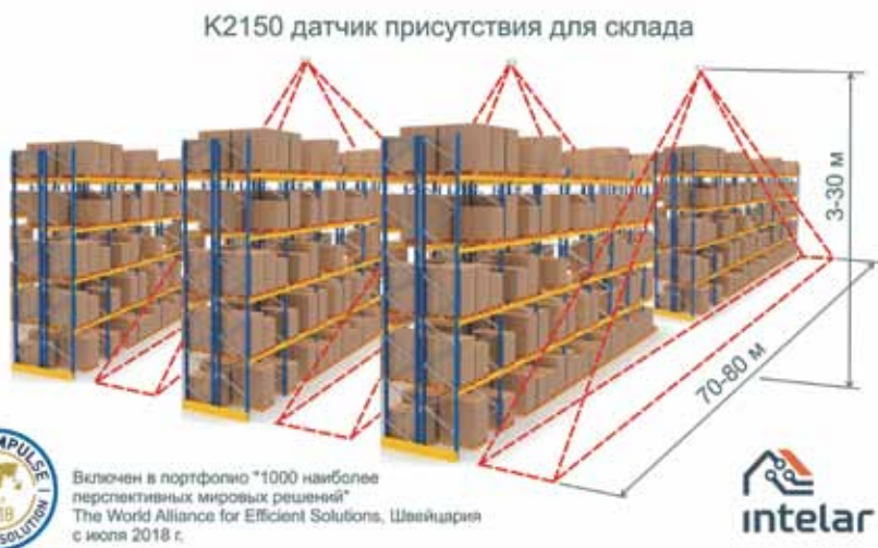
Рис. 3. K2150 – один датчик на 70–80 м межстеллажной аллеи
