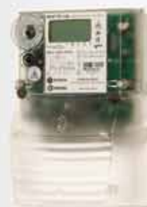
Счетчик 1ф Вектор-100. Соответствует требованиям ПАО «РОССЕТИ», протокол СПОДЭС
