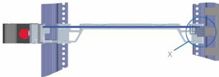
Рис. 1. Типичное исполнение системы с передней панелью, направляющей для карты, печатной платой и кросс-платой
