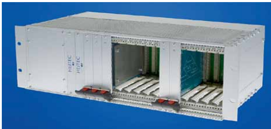
Рис. 4. Конфигурация HeiPac Vario HEAVY для испытания в соответствии с EN 50155, с верхними и нижними защитными панелями, кросс-платой, направляющими для карт, задним защитным кожухом, передними панелями и нагрузочными модулями
