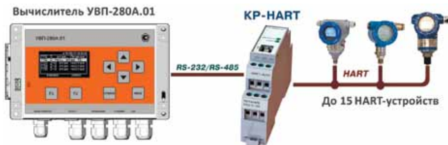
Рис. 2. Подключение контроллера KP-HART к вычислителю линейки УВП-280 в системе коммерческого учета
