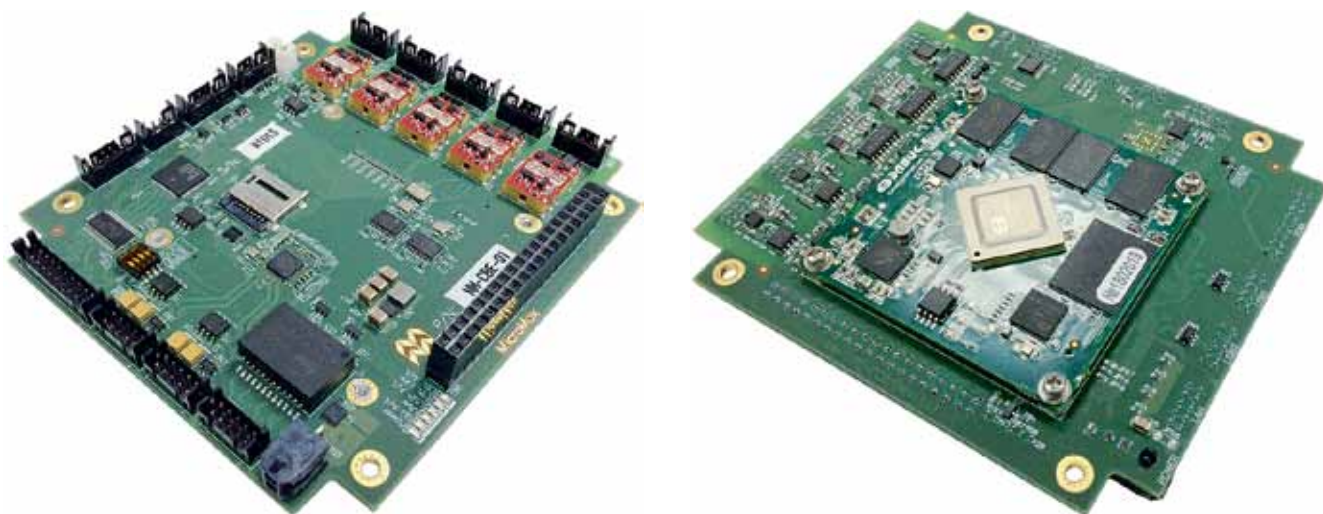
Рис. 1. Процессорная плата MicroMax форм-фактора PC/104
