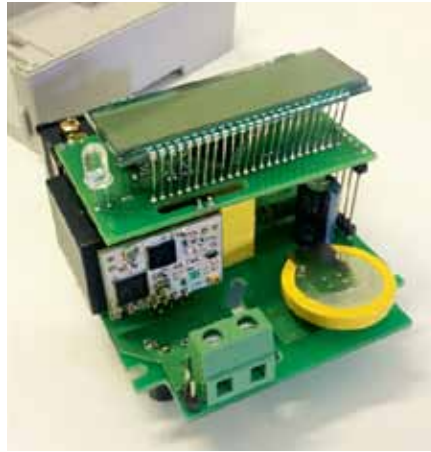
▲ LoRaWAN-модем в счетчике ЦЭ2726А: исполнение на DIN-рейке
