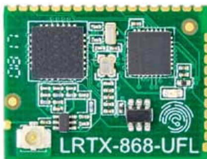
▲ Радиомодуль LPWAN Class A/C с разъемом u.FL
