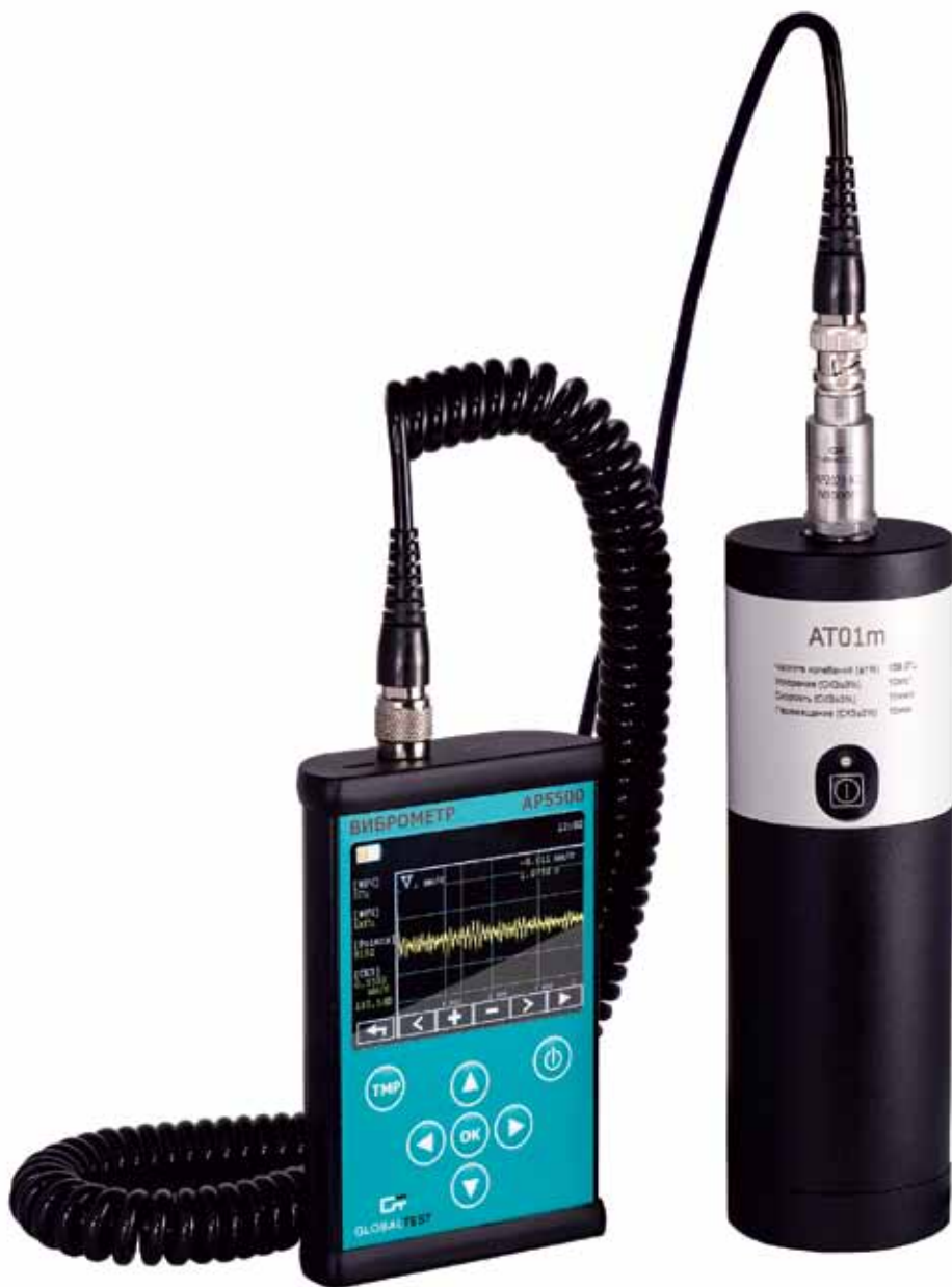
Рис. 3. AP5500 с подключенным к нему портативным калибратором AT01m, служащим для калибровки и проверки работоспособности виброметра
