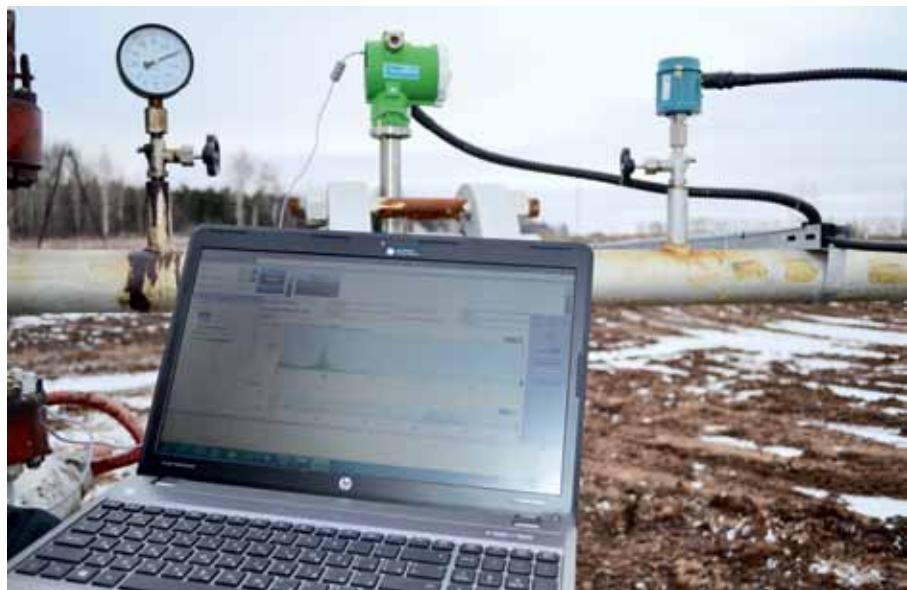
Рис. 2. Настройка расходомера с помощью программы «ЭМИС-ИНТЕГРАТОР» для учета закачиваемой в скважину подтоварной воды (технологический процесс поддержания пластового давления)
