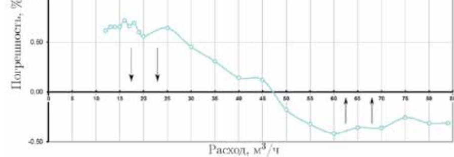
Рис. 7. Калибровка расходомера с помощью корректировочной таблицы
