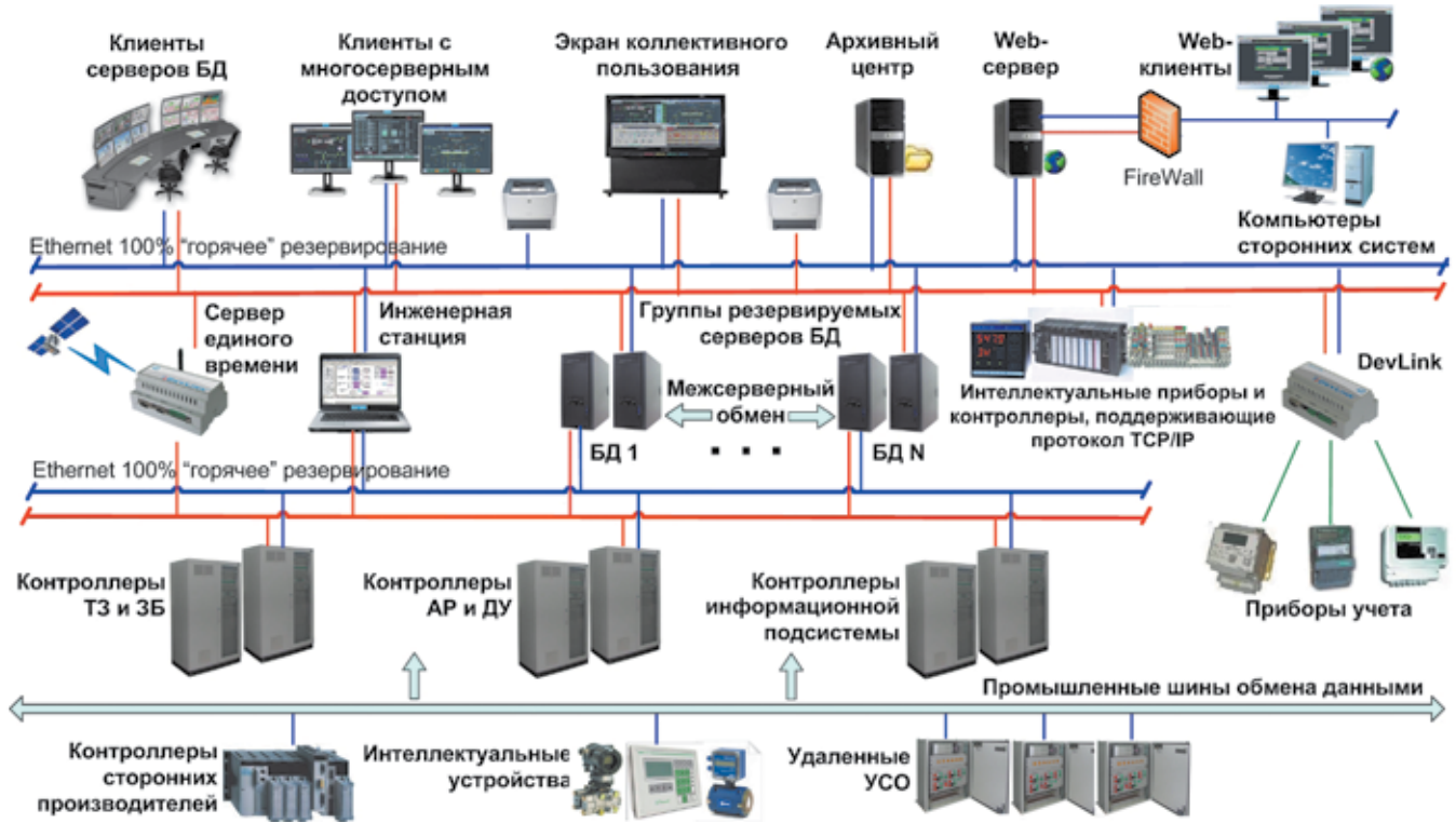
Рис. 1. Архитектура распределенной системы управления
