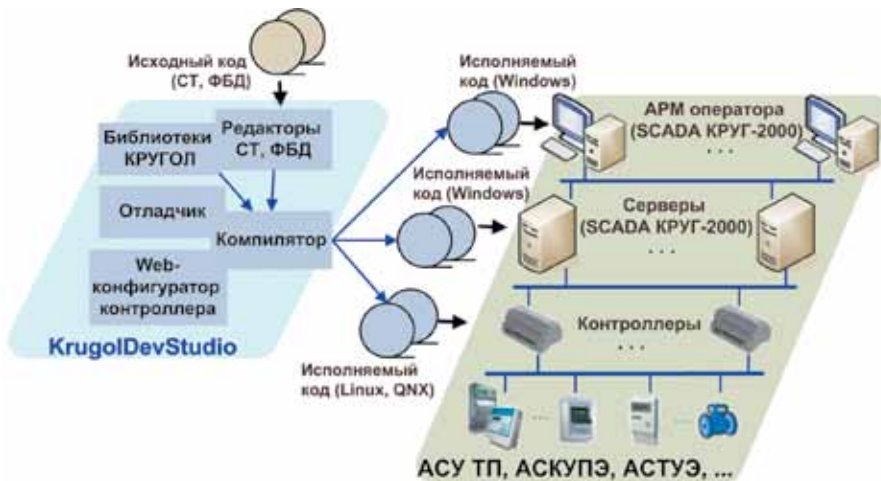
Рис. 2. KrugolDevStudio. Программирование для SCADA и контроллеров
