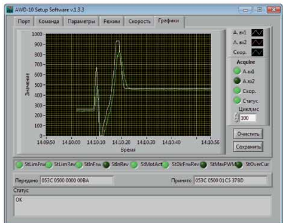
Рис. 3. Программное обеспечение AWD Setup Software. Окно мониторинга параметров
