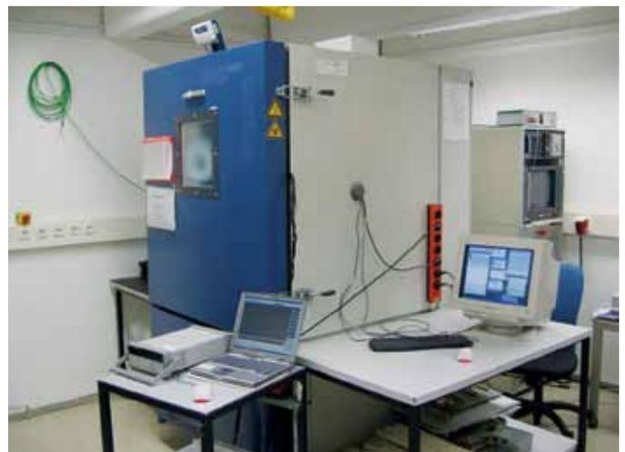
Рис. 2. Климатическая камера, в которую помещаются тестируемые образцы серверов Kontron KISS
