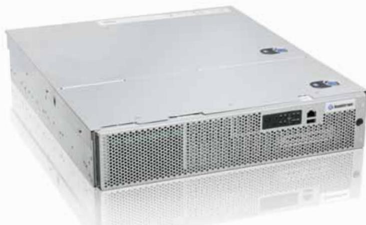
Рис. 3. Так выглядит высокопроизводительный высоконадежный стоечный компьютер Kontron CRMS CG2100 на базе двух шестиядерных процессоров Intel Xeon 5600, поддерживающий резервирование жестких дисков, блоков питания и вентиляторов и допускающий установку до 96 Гбайт памяти типа DDR3
