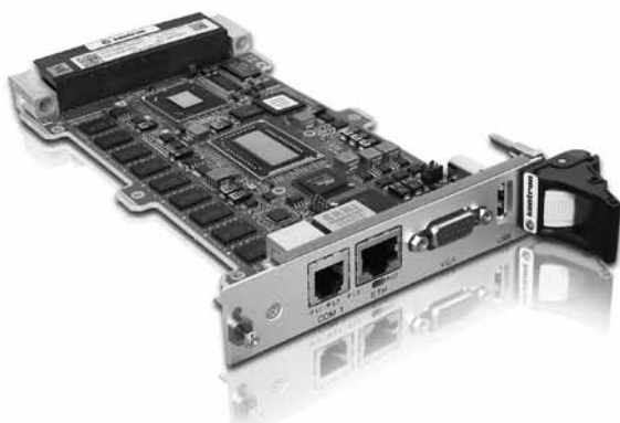
Рис. 4. VPX-модуль Kontron VX3035 высоты 3U, оснащающийся процессором Intel Core i7 2655LE и доступный в жестком кондуктивном исполнении для температурного диапазона -40 \dots +85 \text{ }^\circ\text{C}
