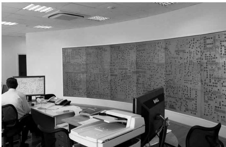
Рис. 5. Видеостена на базе 18 ультратонких видеокубов Planar Margay II
